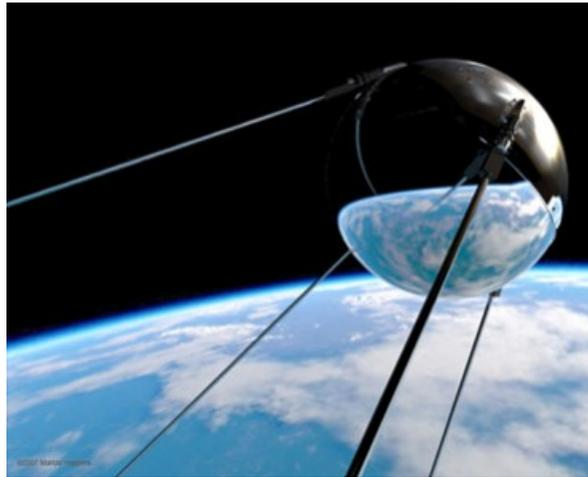
El Sputnik fue lanzado desde el cosmódromo de Baikonur coincidiendo con el Año Geofísico Internacional. Era una esfera de aluminio de 58 cm de diámetro y 83kg de peso con cuatro antenas colocadas en posición oblicua, y dos transmisores de radio en las frecuencias de 20,007 y 40,002 MHz, cuyas señales fueron usadas para obtener información sobre la concentración de electrones en la ionosfera.
